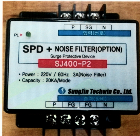
제품명 : 저압 서지보호장치 정격 : In 20 kA, AC 300 V(L-N), AC 400 V(L-PE, N-PE)
